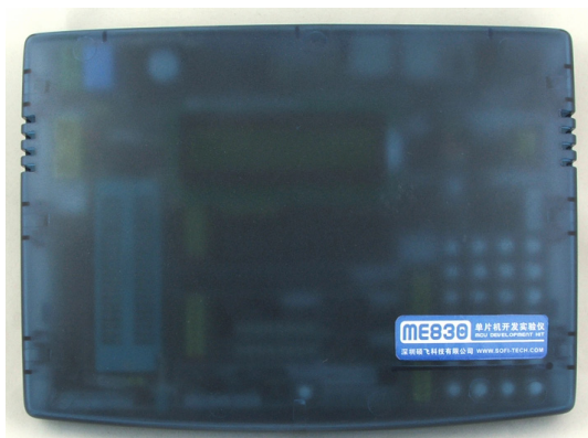
图 1.1 ME830 主机外观 (尺寸 190x138x38mm)
